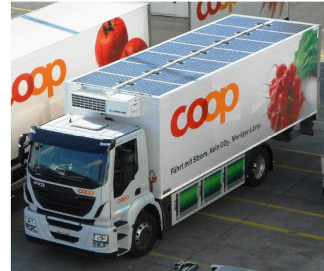
Camion électrique de 18t équipé de panneaux photovoltaïques de 3 kWc. La récupération et les panneaux PV intégrés fournissent 30 kWh, soit environ un quart de sa consommation. Source : [www.solaragentur.ch](http://www.solaragentur.ch)
