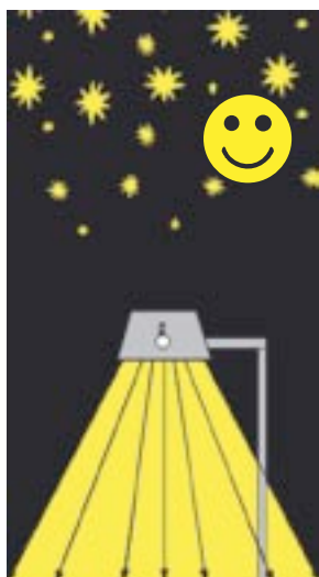
Un lampadaire muni d'un capuchon adéquat canalise la lumière vers la surface à éclairer, sans dispersion inutile.
