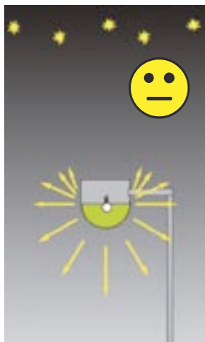
Un lampadaire muni d'un capuchon insuffisant diffuse de la lumière vers le ciel.
