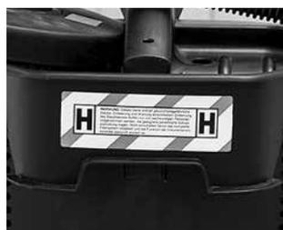
Les filtres de classe M ou L sont insuffisants pour retenir les fibres d'amiante particulièrement fines.
