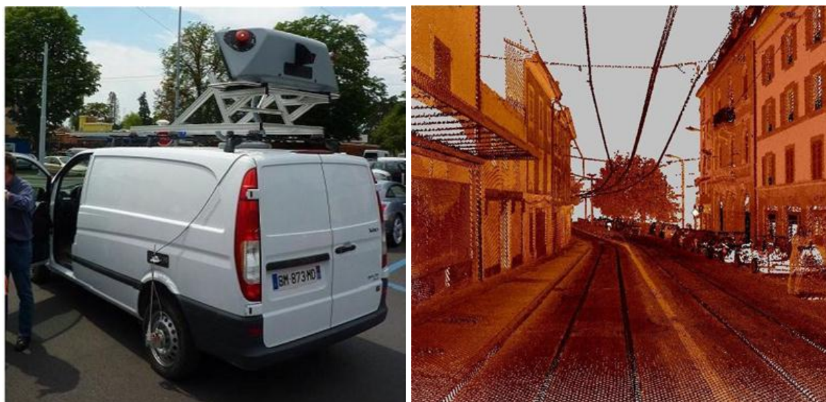
Figure 2.8 Photo du système d’acquisition et image du nuage de points brut (source : HKD)
