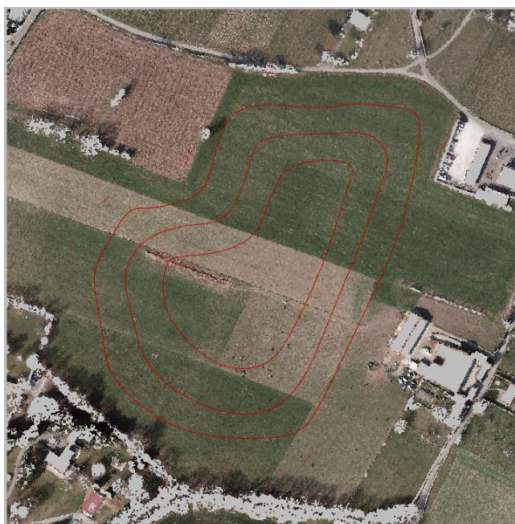
Figure 4.3 Création d’un dôme par dessin de courbes de niveau
