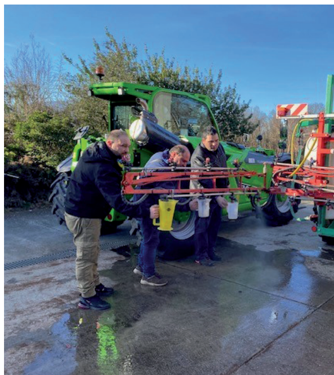
Exercice de réglages de pression et des buses d'un pulvérisateur, février 2024, Lullier
