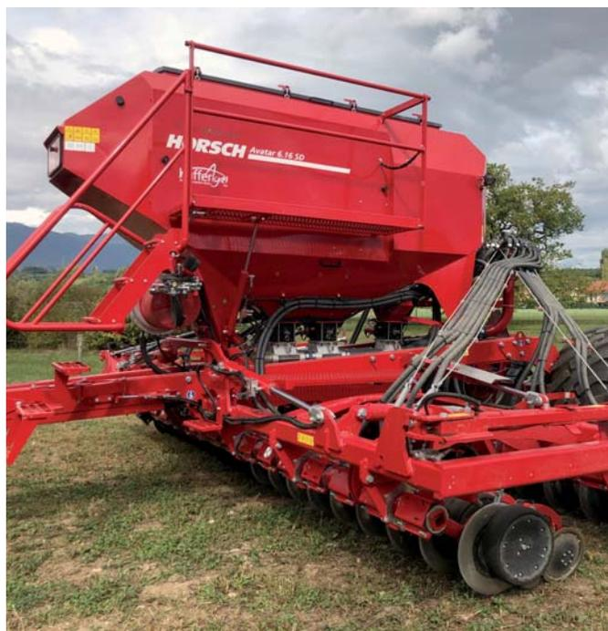
Semoir de semi-direct, permettant de déposer les semences dans le sol sans travail préalable, afin de ne pas détruire la structure du sol, de préserver ses capacités d'absorption et de rétention en eau, ainsi que la vie des micro-organismes.
