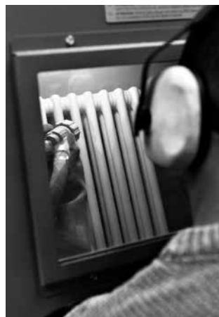
SABLAGE EN CABINE
