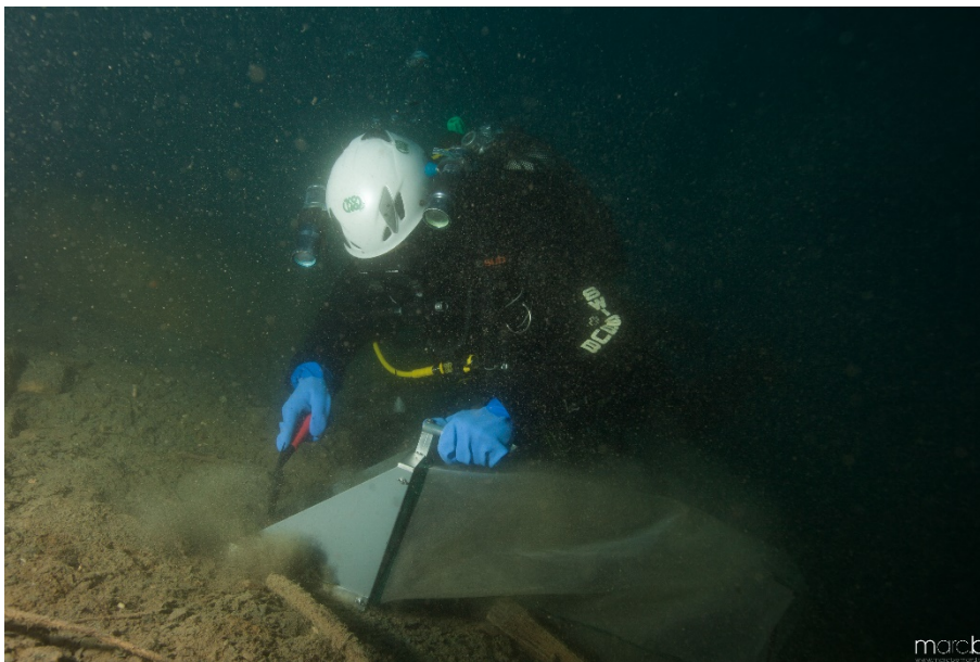
Figure 3: Prélèvement subaquatique à l'aide d'un filet Surber modifié et d'une pelle (photo M. Bernard).
