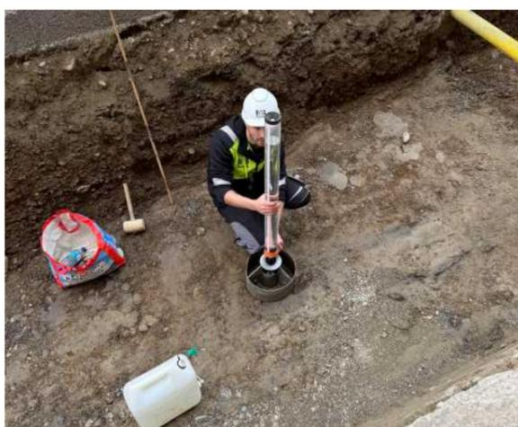
Test d'infiltration sur fond de forme
