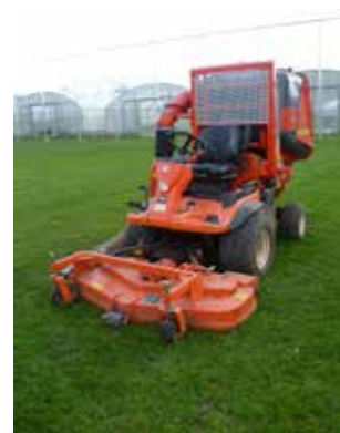
Tondeuses rotatives à disque avec bac de ramassage, permettant une coupe haute. A gauche, la plus courante pour de petites surfaces. A droite, adaptée aux grandes surfaces.
