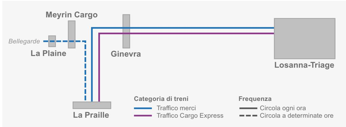
Entro il 2035, l'offerta in percorsi dovrebbe consentire di collegare direttamente Losanna-Triage e Vernier-Meyrin Cargo, senza dover transitare attraverso La Praille, al fine di rafforzare il polo logistico ZIMEYSAVER.
