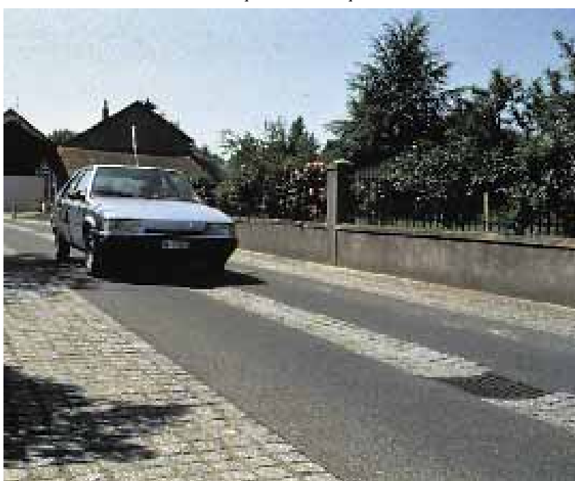
Les caniveaux superficiels découpent la route et modèrent le trafic
