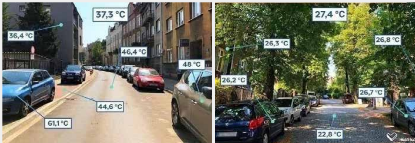
Dans certaines configurations, rien qu'à l'échelle de la rue, un alignement de platanes abaisse la température de 2 à 3 degrés. Au contraire, une zone étanche à l'eau et exposée au soleil peut chauffer jusqu'à plus de 60°C en été et ainsi conduire à des températures de l'air très élevées à proximité source site Climate Action.
