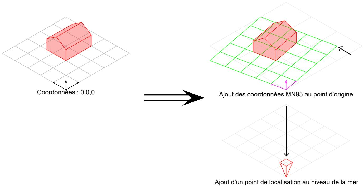
Le principe du géoréférencement d'une maquette BIM dans Archicad est le suivant :
