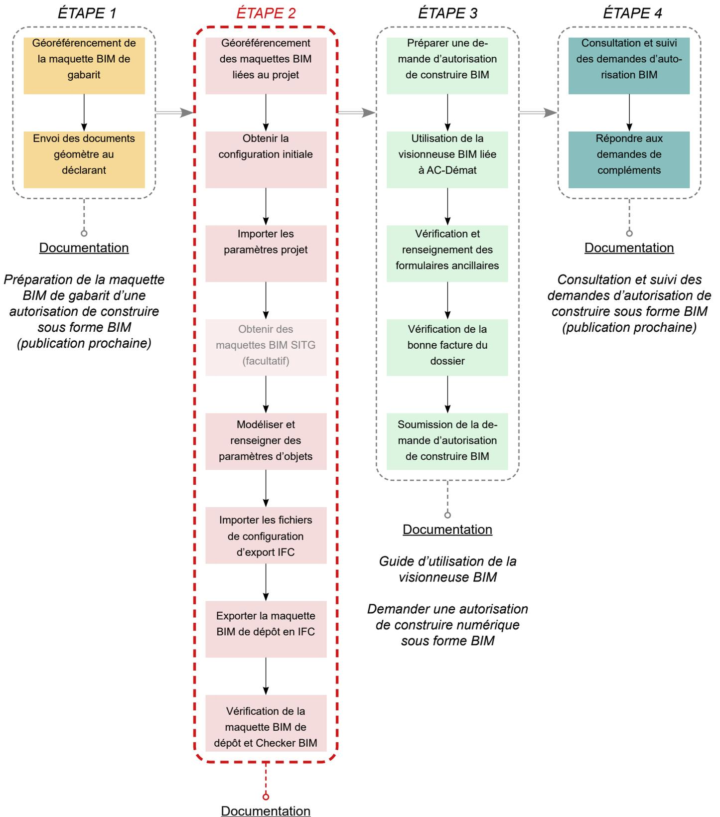
« Norme IFC de dépôt d'une autorisation de construire sous forme BIM » : Exigences de Modélisation BIM applicable aux demandes d'autorisation de construire
