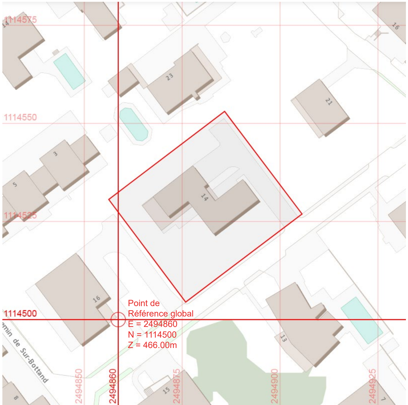
Position de la parcelle et du point de référence global sur la grille du système géodésique MN95.
