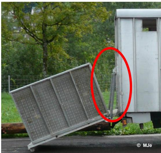
*Jonction correcte entre le véhicule et les protections latérales de la rampe*
