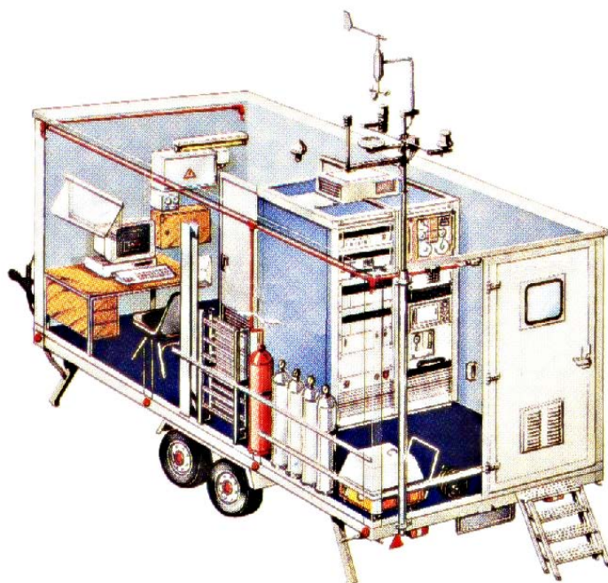
Figure 1. Schéma en transparence d'une station mobile.
