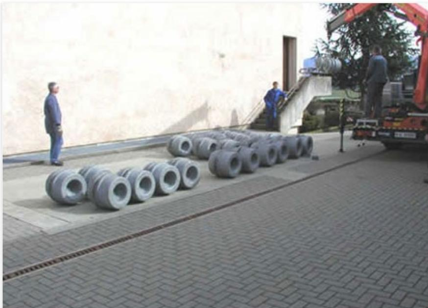
La charge du pont-bascule ira jusqu'à 5'000 kg, 10'000 kg puis 15 '000 kg. Un bulletin de pesage est régulièrement imprimé et le résultat consigné dans un protocole de contrôle.
