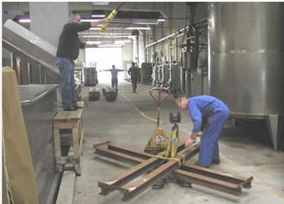
Les quatre côtés de la cuve sont vérifiés par des excentrations au moyen de deux poids étalons coulissant sur le rail d'un bord à l'autre. Ceci permet de s'assurer qu'il n'y a pas de dérive sur un angle.
