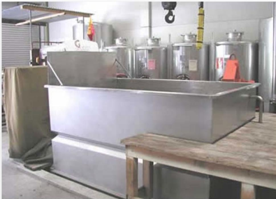
Avant de procéder au contrôle, l'inspecteur veille à ce que la cuve soit entièrement libre et ne touche pas sur les bords. Une petite friction sur le côté peut en effet fausser la mesure.
