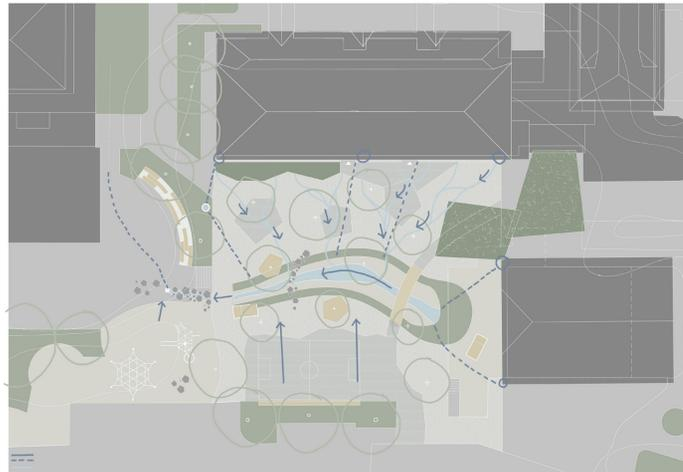
Gestion des eaux par infiltration partielle dans les sols sur les revêtement type graviers et pavés filtrants. Dirrection des eaux de ruissellements dans la noue grâce aux pentes du terrain. Gestion des eaux de toitures par infiltration dans les sols et par ruissellement en surface, canalisations de celle-ci et deversement dans la noue. Canalisation des eaux de la noue si trop plein puis raccordement sur canalisations existantes.
