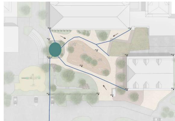
Schéma d'écoulement et de récupération des eaux de surface
