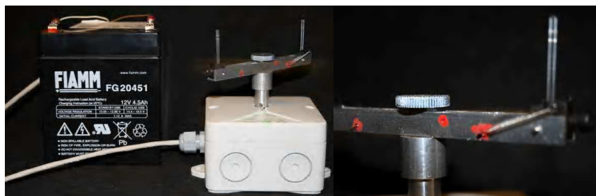
Figure 6 : Le Rotorod et sa batterie (à gauche). Vue de détail d'une baguette en rotation (à droite). Photos S. Ingold.
