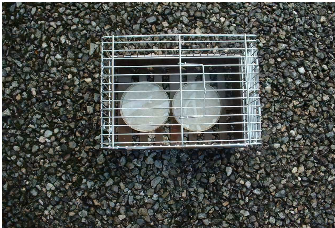
Figure 3 : Type de cage utilisée avec deux boîtes de Pétri avec un milieu PDA + Filtre (Photo Calmin G.).
