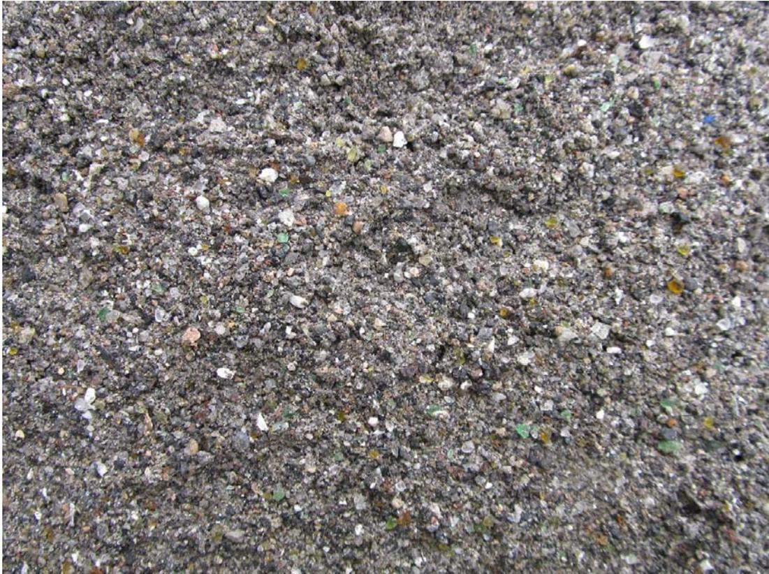
*Fig. 6: Sable de mâchefers issus du deuxième essai.*
