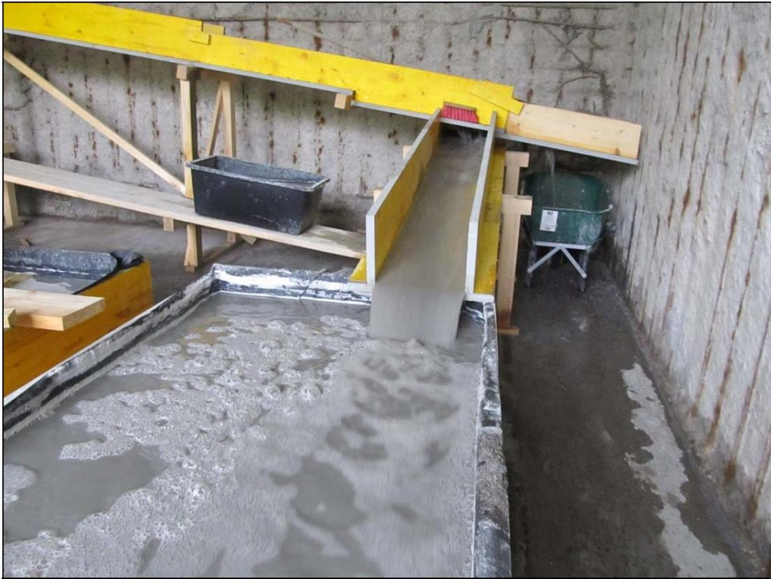
Figure 3: Installation de lavage et récupération des métaux denses par gravimétrie construite pour le premier test de 2017.
