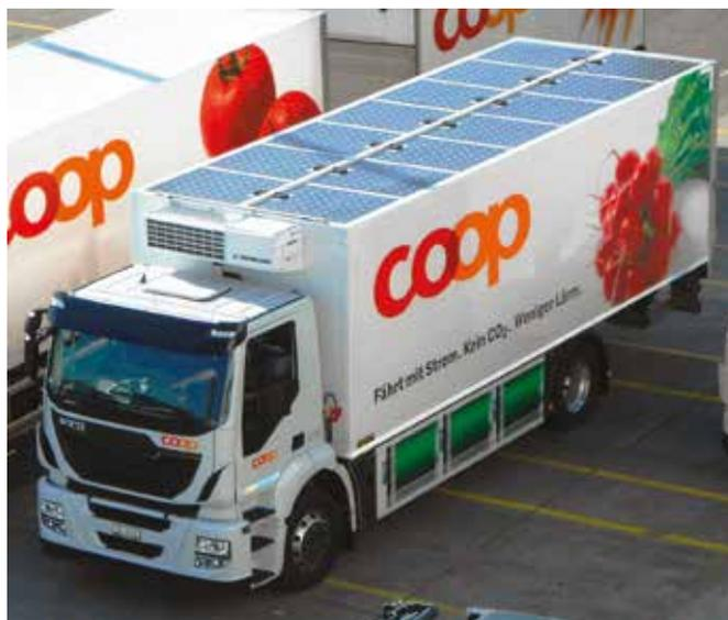
*Camion électrique de 18t équipé de panneaux photovoltaïques de 3 kWc. La récupération et les panneaux PV intégrés fournissent 30 kWh, soit environ un quart de sa consommation. Source : [www.solaragentur.ch](http://www.solaragentur.ch)*
