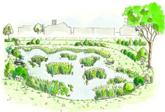
Le bassin en eau est un ouvrage surfacique de rétention et/ou de décantation, constitué d'un plan d'eau permanent et d'une zone de marnage destinée à la gestion des eaux.
