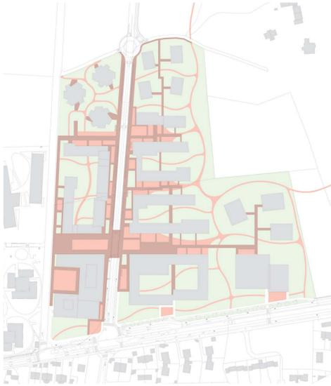
Un système orthogonal carré prévu pour les dessertes fonctionnelles et les accès piétons aux bâtiments, permet de structurer l'espace à disposition et délimite les surfaces dédiées aux usages de quartier. Les franges du quartier et les espaces de la lisière sont parcourus par un réseau cycle et piéton plus courbe, adapté à la promenade et à la découverte du contexte paysagé : forêt, prairie, strate arbustive, connexions aux champs agricoles.
