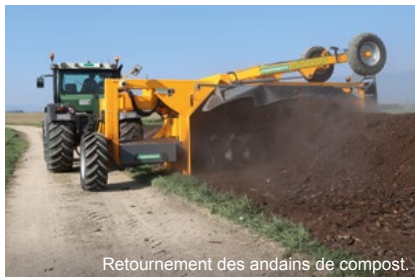
Retournement des andains de compost.
