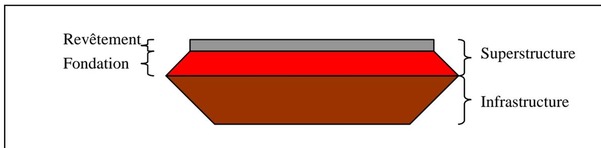
Figure 14 : Nomenclature pour la structure d'une chaussée. (Source : Ecoservices, 2005)
