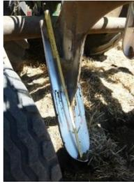
Dans certains cas particuliers, l'évaluation pédologique peut conclure à l'utilisation d'une sous-soleuse à dent droite très profonde, préalablement ou en substitution de la bêcheuse défonceuse. Néanmoins, avec une sous-soleuse, l'effet de fragmentation entre les dents est fortement limité; son rôle est essentiellement un rôle de drainage de l'eau en excès.
