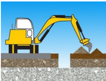
Reprise des matériaux de l'horizon inférieur depuis un chemin existant adjacent à la fouille.
