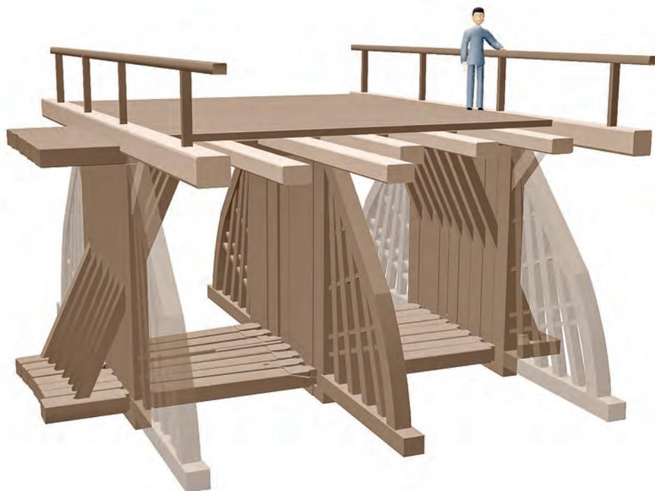
**12** Reconstitution 3D de la pile de pont, avec renfort longitudinal sur l'axe central.
