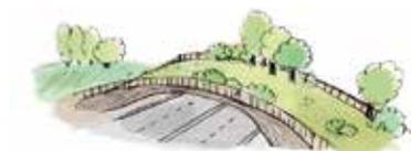
Les passages à faune supérieurs permettent généralement à la faune de passer par dessus de grandes voies de circulations. Il existe:
