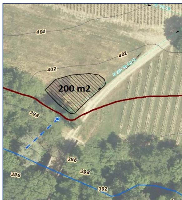
**Figure 2:** implantation d'un bassin tampon à l'amont du rejet polluant
