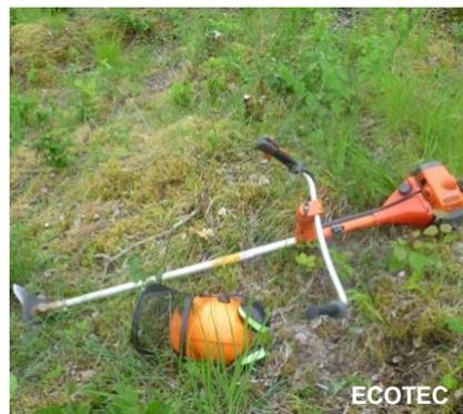
Débroussailleuse à lame
