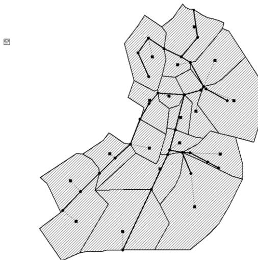
Figure 3 : exemple de réseau exporté d'ArcGIS dans SWMM
