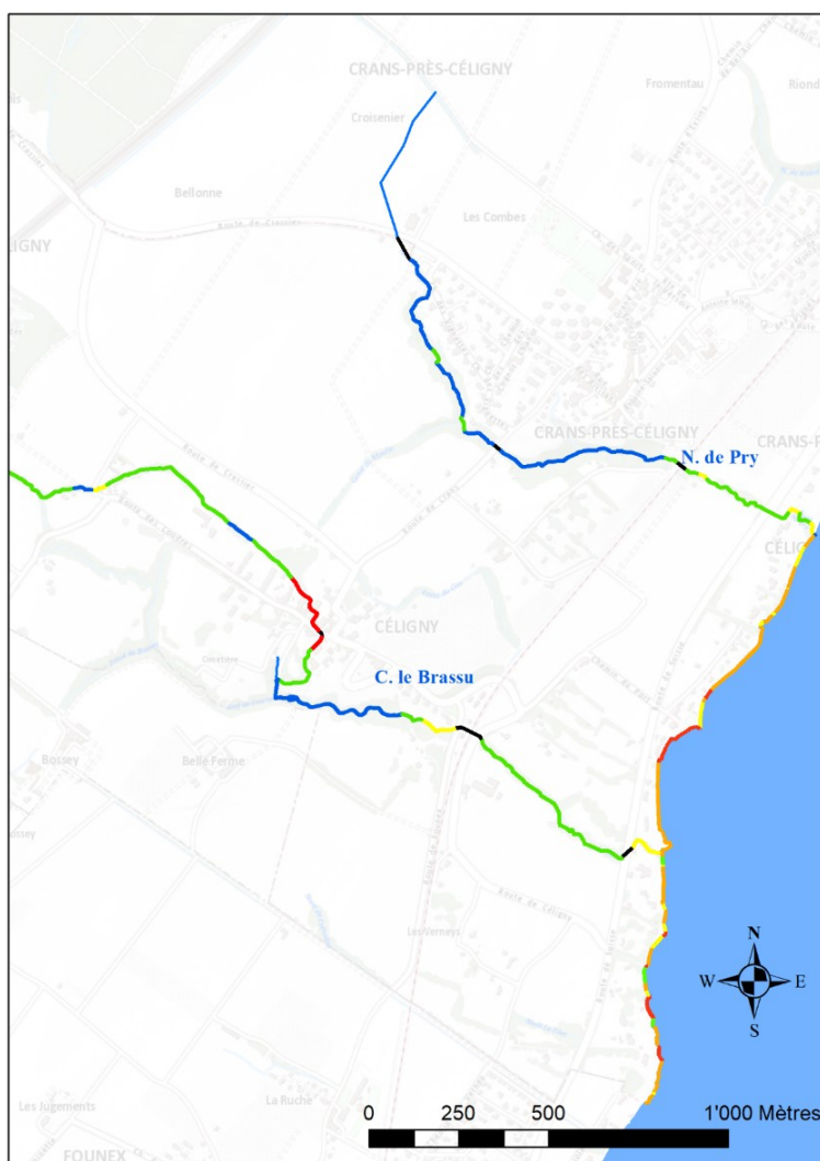
Figure 1a : Ecomorphologie des cours d'eau et des rives lacustres du secteur, partie nord (Bleu = naturel/semi naturel, vert = peu atteint, jaune = très atteint, orange = très dégradé, rouge = artificiel, noir = mis sous terre)
