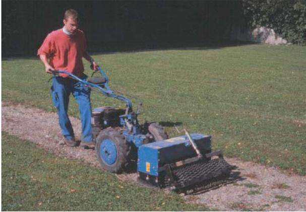
Les équipements mécaniques arrachent la couche portante et la mélangent avec la couche de protection
