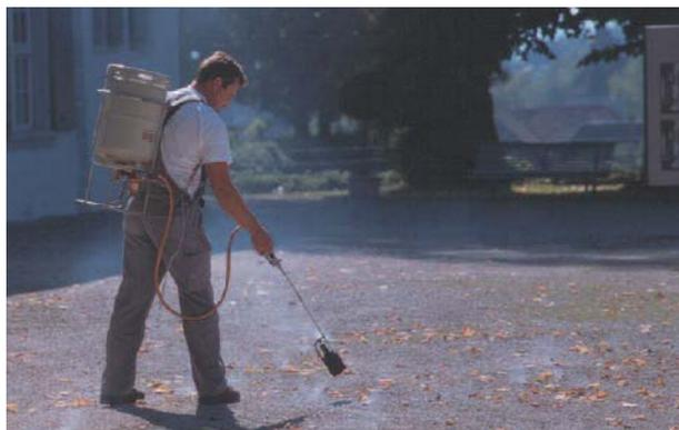
Les procédés thermiques endommagent irréversiblement par la chaleur un nombre suffisamment important de cellules pour tuer la plante. Les appareils conjuguant l'effet thermique et physique de la vapeur d'eau (130°C / 60 bar) conviennent bien pour l'élimination des mousses et pour le nettoyage de surfaces dures. Cette méthode est coûteuse et abîme les joints.
